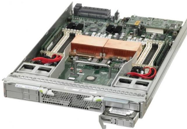
Figure 3: Sun Blade X6220 Server Module <sup>2</sup>
